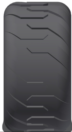
Falta de pressão
